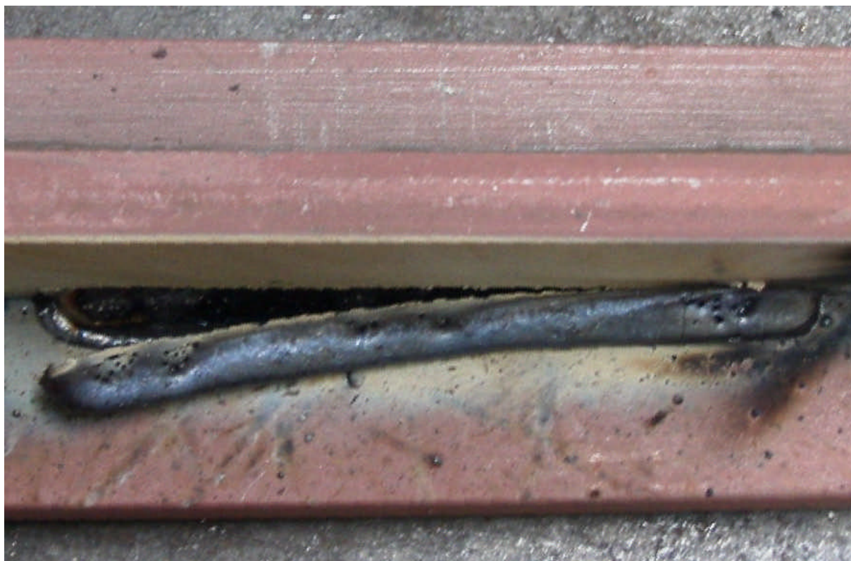
Hoeklassen met Gonia 180 op geprimerte plaat. Een hoogrendementelektrode met een gesloten zelflossende slak.
